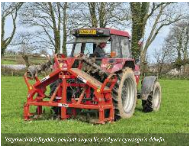
Defnyddiwch isbriddiwr tir glas sy'n gallu mynd i ddyfnder o 28-30cm (10-12mod) ond cymhwyswch y dyfnder fel nad yw'n mynd yn is na 2cm o dan y cywasgiad.
